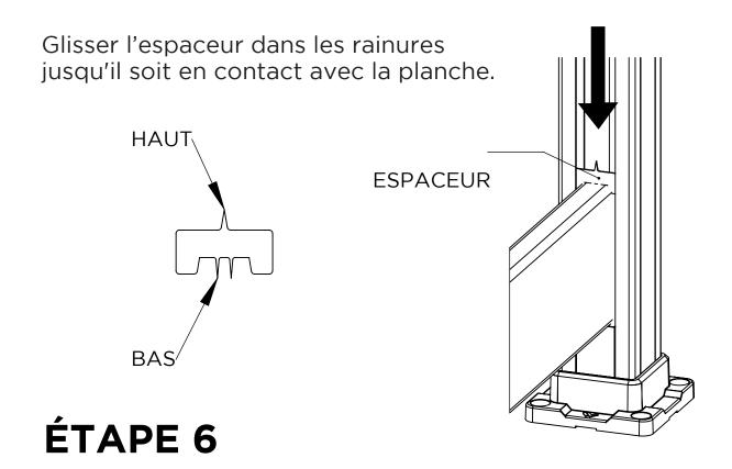
Glisser la seconde planche dans les rainures. Une fois en place, taper sur le dessus de la planche avec un marteau pour la fixer en place. Répéter l'étape 5 et 6.
