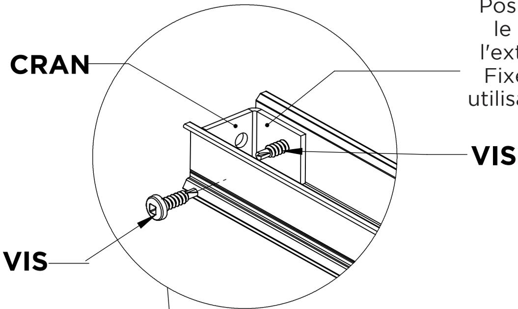
Positionner le cran à l'extrémité. Fixer le en utilisant 2 vis.
